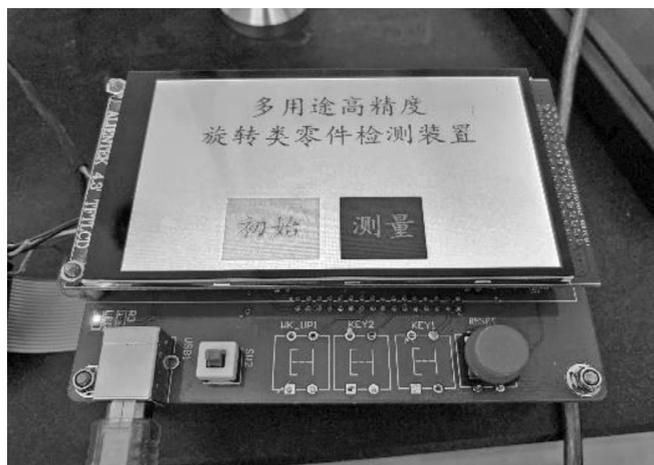
图 7 自主研发手持式测量控制盒及电路图
