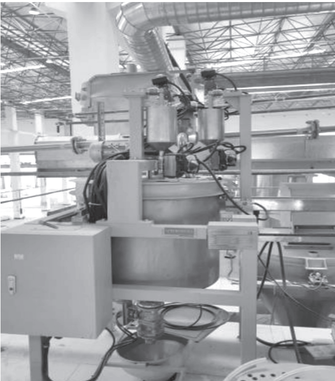
图 7 组合式称重控制色浆混合搅拌机
