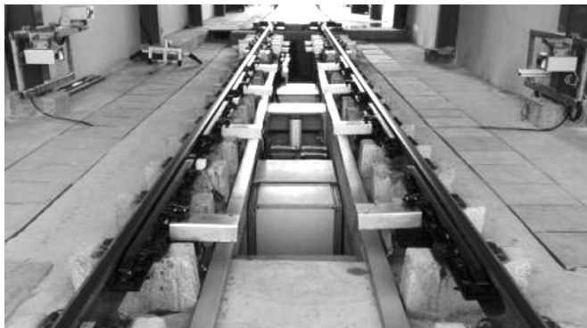
图6 轨旁转向架监测系统
