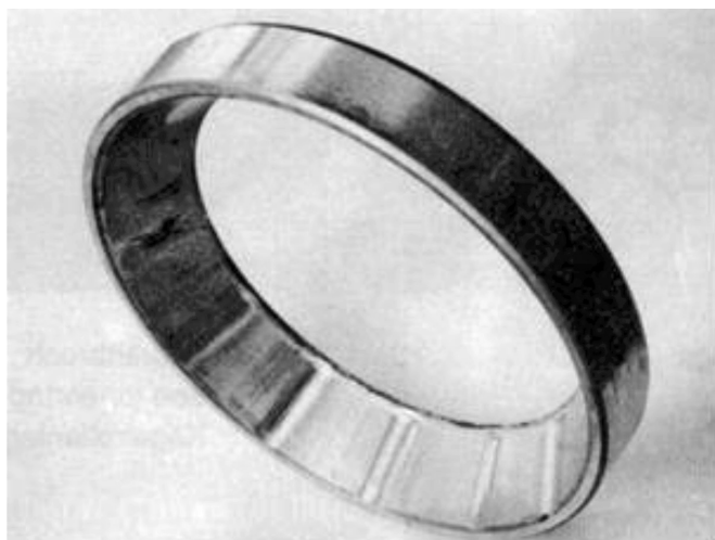
图2 轴承外圈内滑道压痕
