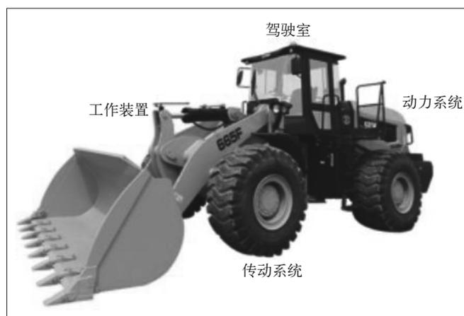
图1 装载机的基本结构
