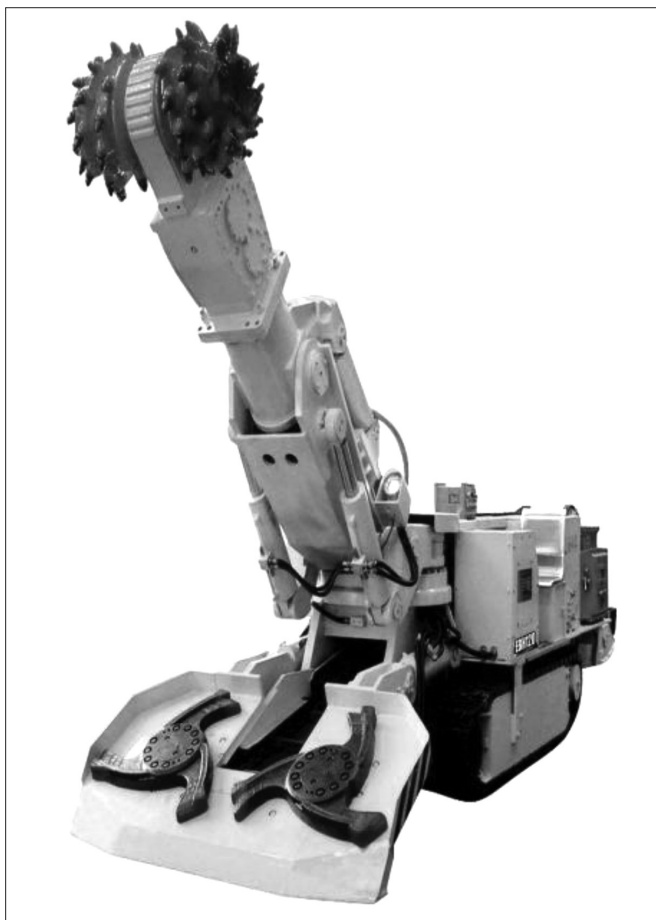
图1 悬臂式掘进机 (EBZ系列悬臂式掘进机)
