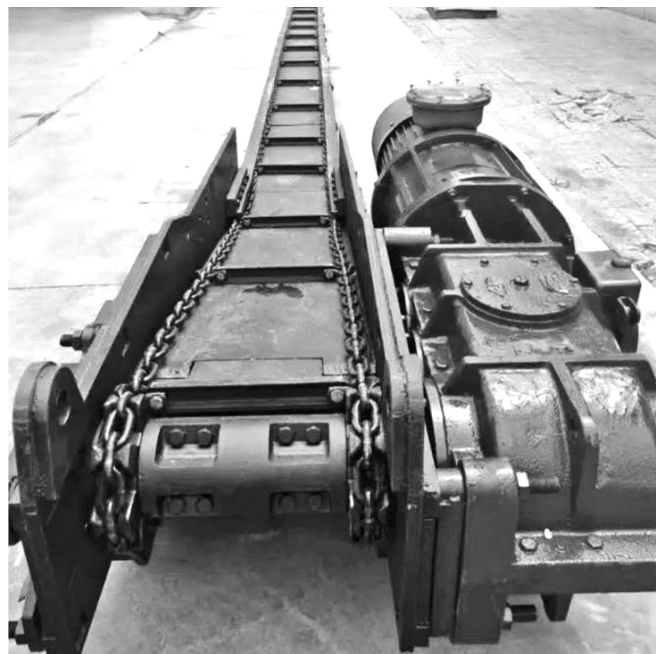
图2 矿用刮板输送机 (40T刮板机整机)
