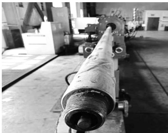
图2 钻具接长后观察弯曲情况
