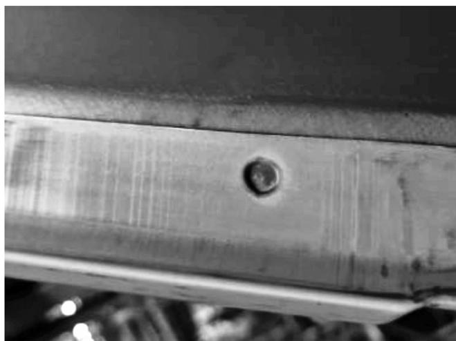
图 1 未垫铜板的焊接效果
