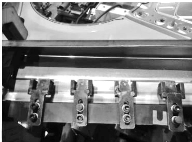
图 2 垫铜板进行焊接
