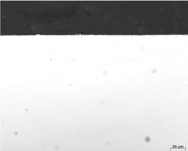
图 2 电镀锌（7μm）退镀螺母镀层金相照片
