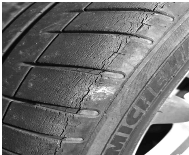
图1 某高原特长隧道项目老化的橡胶
