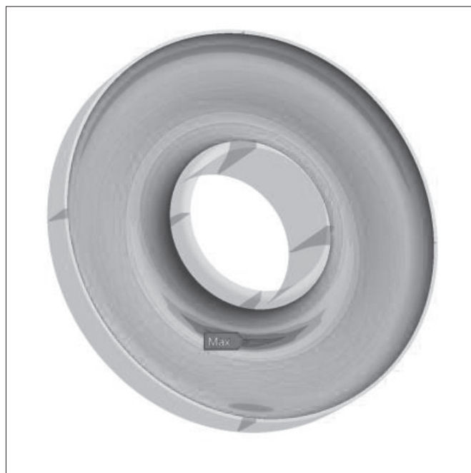
图 8 磨耗轮辐板应力云图
