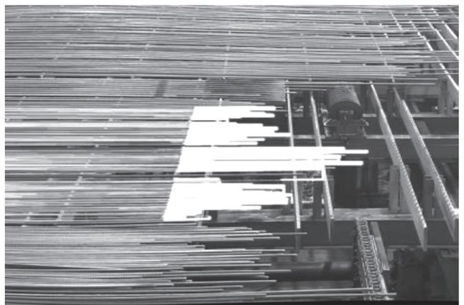
图4 棒材过长部分轮廓框选效果图
