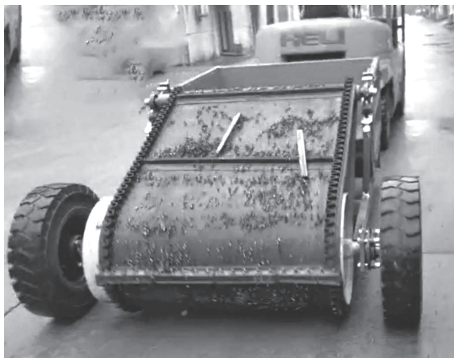
图4 磁力吸铁车吸铁试验效果图
