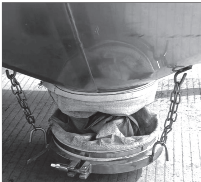
图 3 机械化酿酒车间实际应用的曲粉混合转运装置
