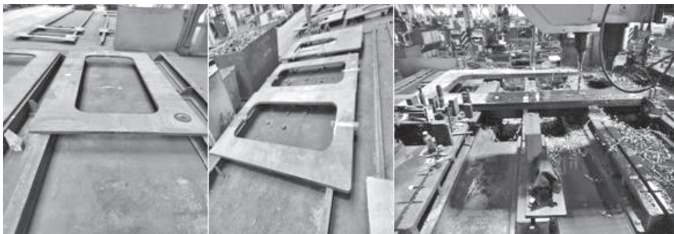
图6 法兰横向拼装、钻孔加工
