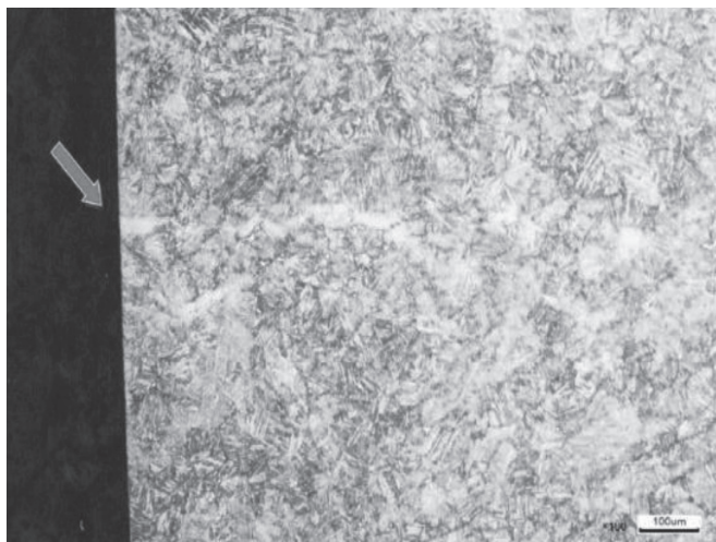
图 6 A 轴表面磁痕堆积处横向截面组织
