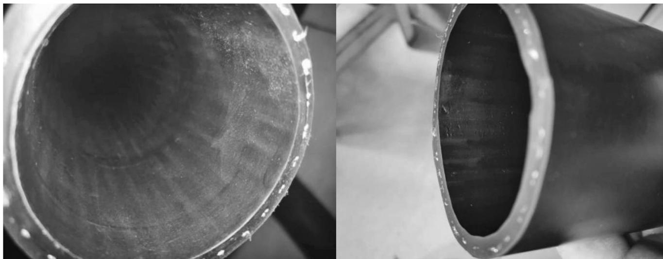
图2 胶管内部水波纹和流水槽图
