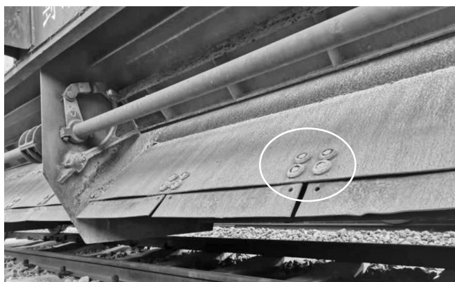
图 8 现车流砑调整板紧固结构
