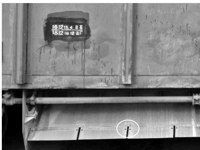
图 9 标准 K13NK 车流砑调整板紧固结构
