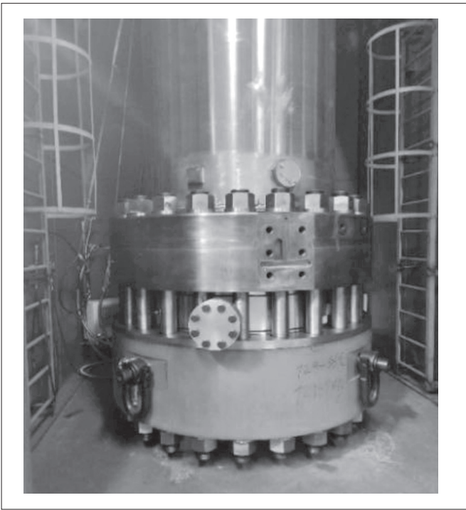
图 3 屏蔽主泵电机放置于试验工作台
