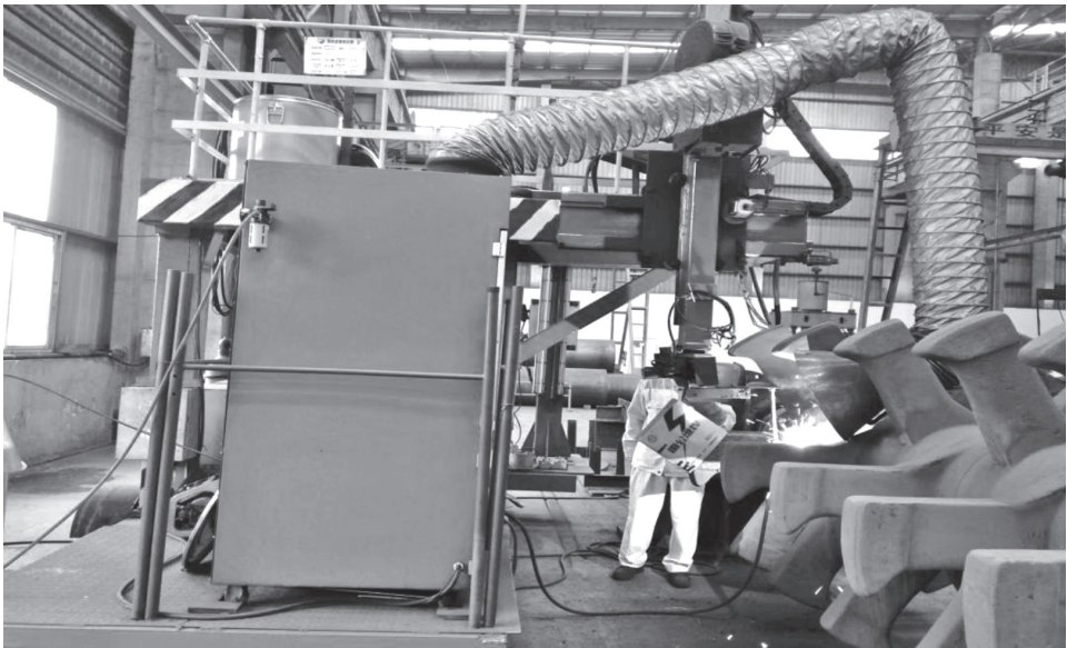
图 5 单人操作自动堆焊焊接过程
