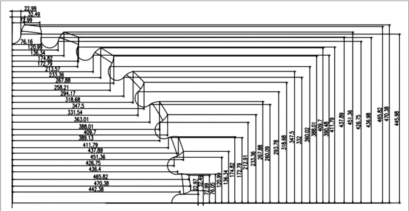
图 1 销齿齿轮齿形尺寸图
