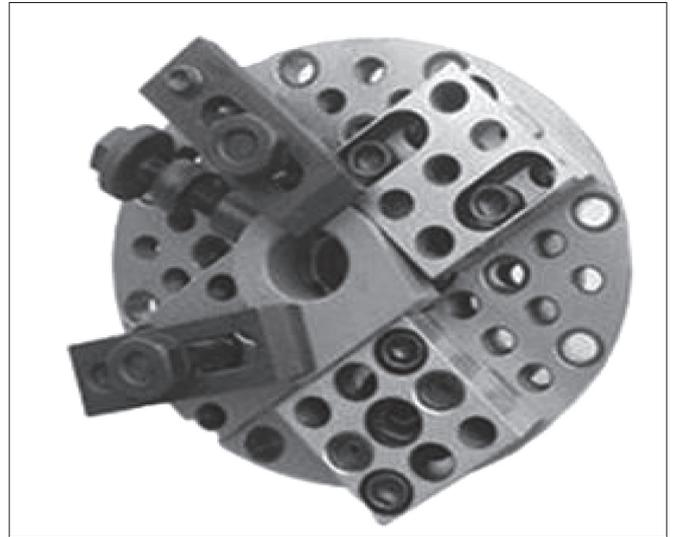
图2 孔系组合夹具示意图
