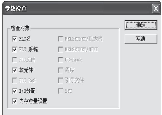
图 13 手动梯形图程序参数检查
