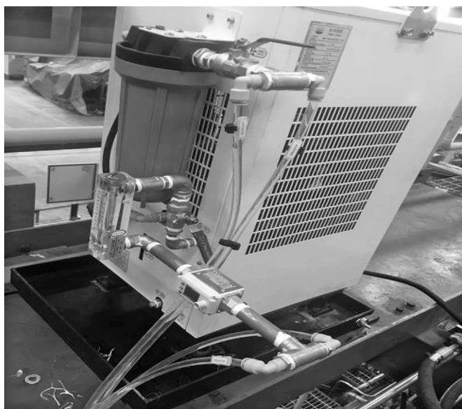
图 1 改进后的水冷系统
