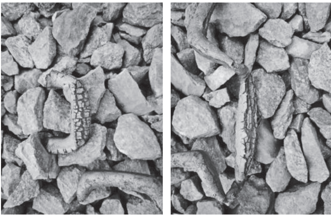
图 4 正常情况下钢轨焊接轨顶焊瘤(左)和轨底轨腰焊瘤(右)
