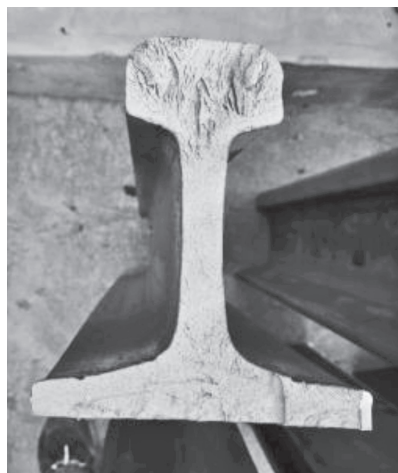
图 5 标准作业砸断后钢轨断口
