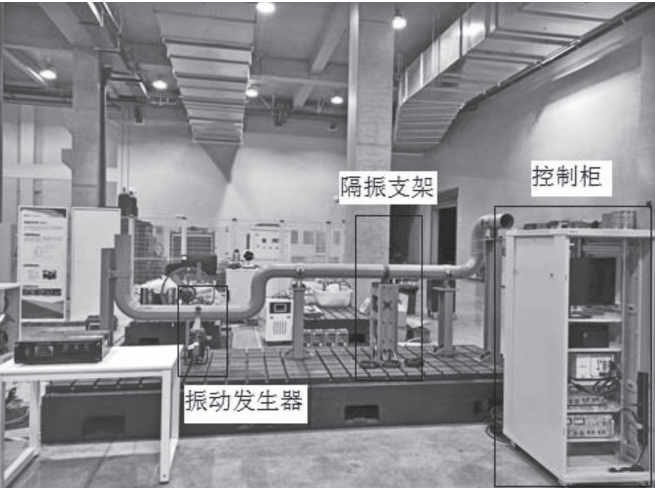
图 5 安装完成的试验台架
