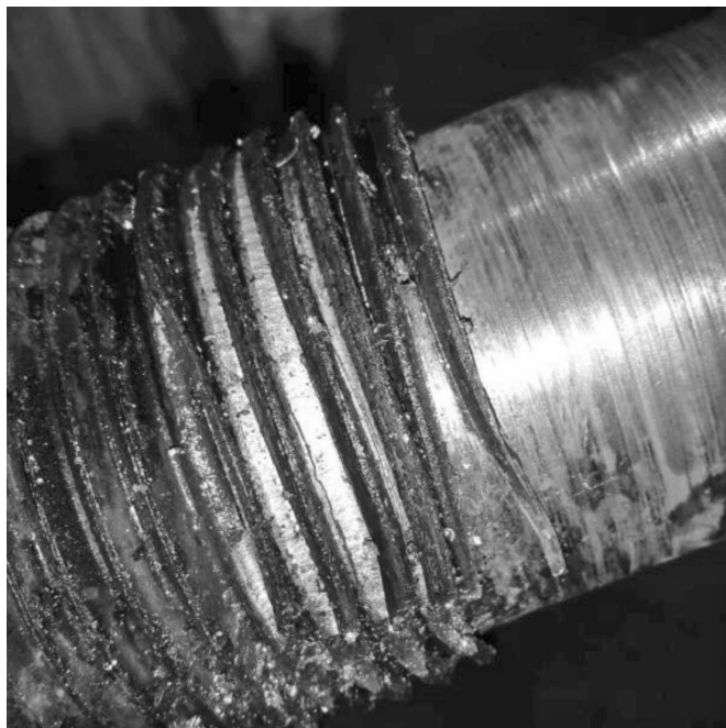
图 5 破拆预紧力释放瞬间螺纹崩裂
