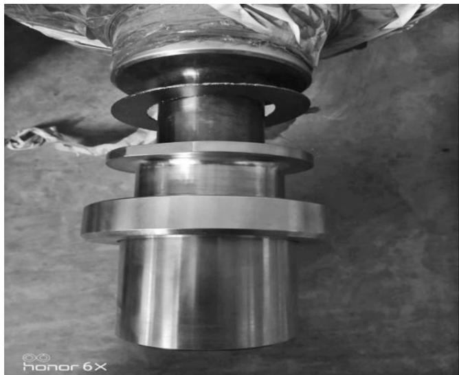
图 4 安装轴套轴瓦严格按安装说明装配
