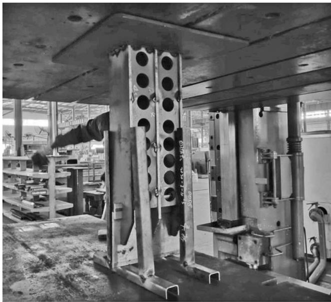
图6 刀具加长工装图
