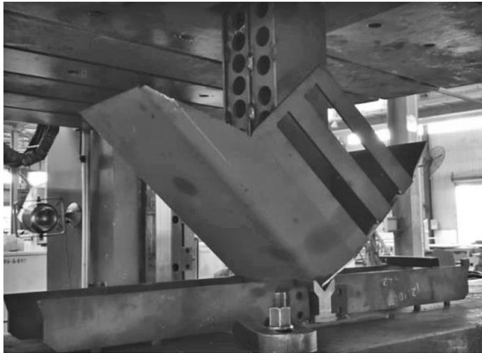
图9 砂箱外侧板、内侧板成型
