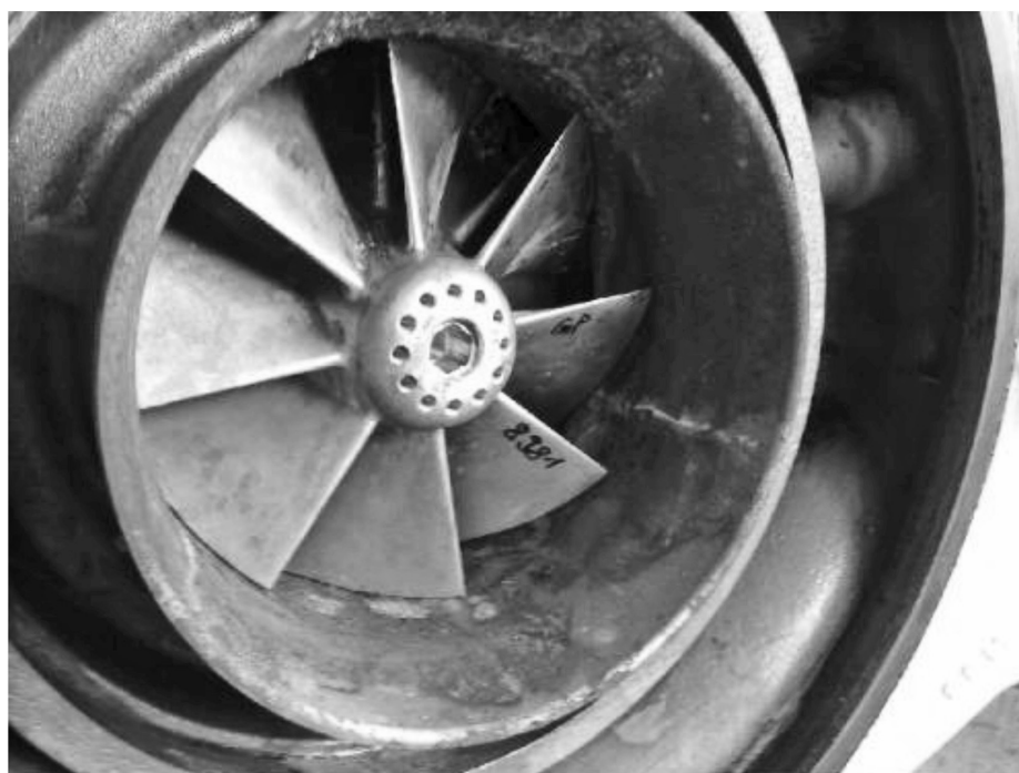
图 2 凝露导致的燃气发动机涡轮增压器锈蚀
