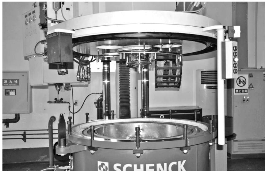
图 7 涡轮盘超转试验
