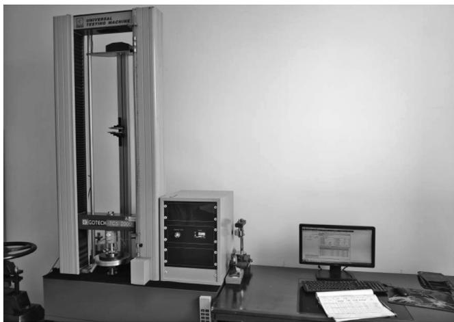
图 1 电子拉力机
