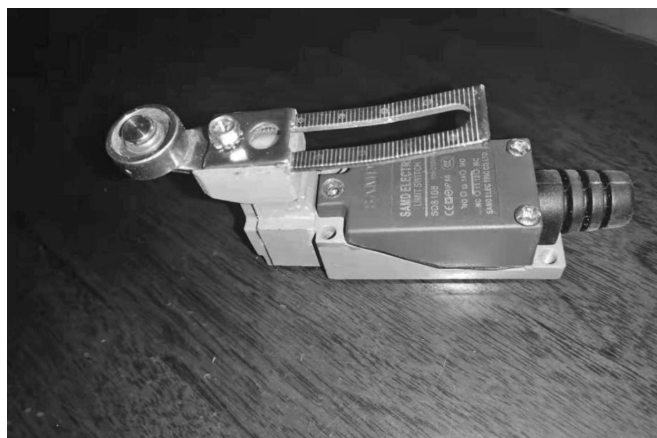
图4 停车设备横移栽车板失效的限位
