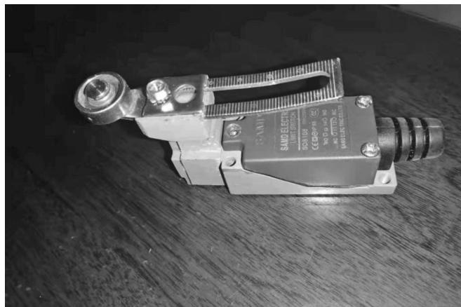
图4 停车设备横移栽车板失效的限位
