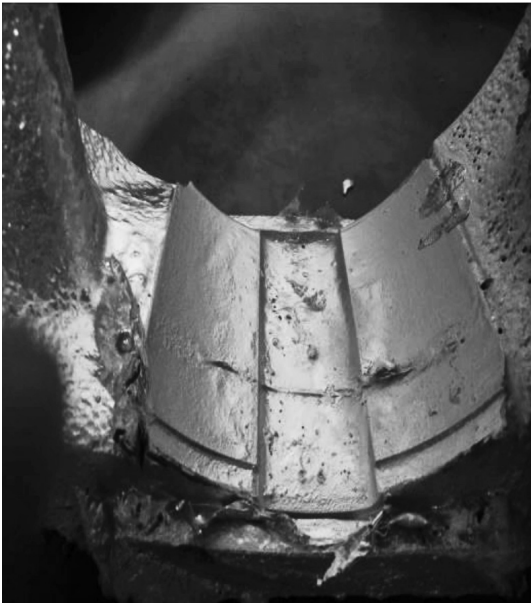
图 2 轴瓦磨损情况
