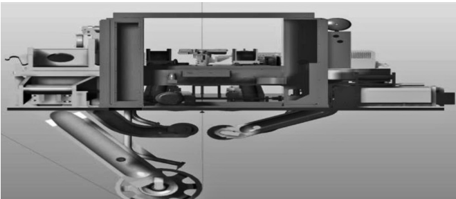
图 1 气刀三辊六臂装配图
