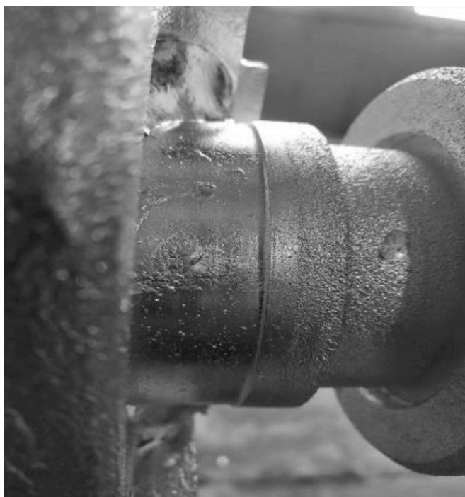
图 5 轴套磨损情况
