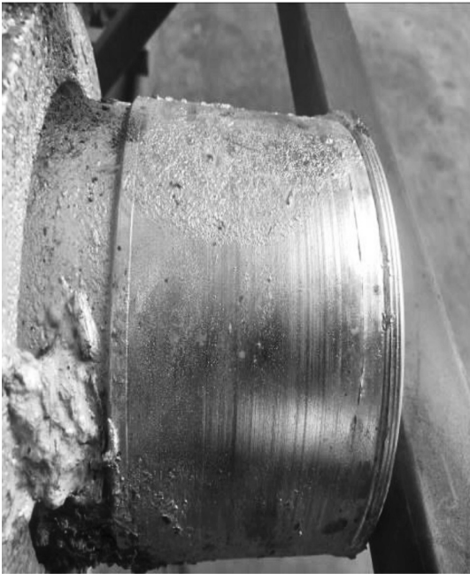
图 3 轴套磨损情况
