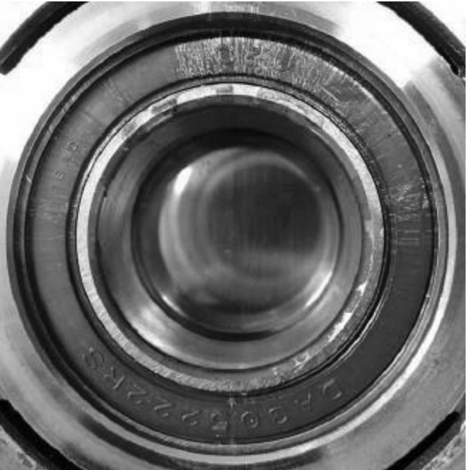
图 1 试验后产品漏脂外观
