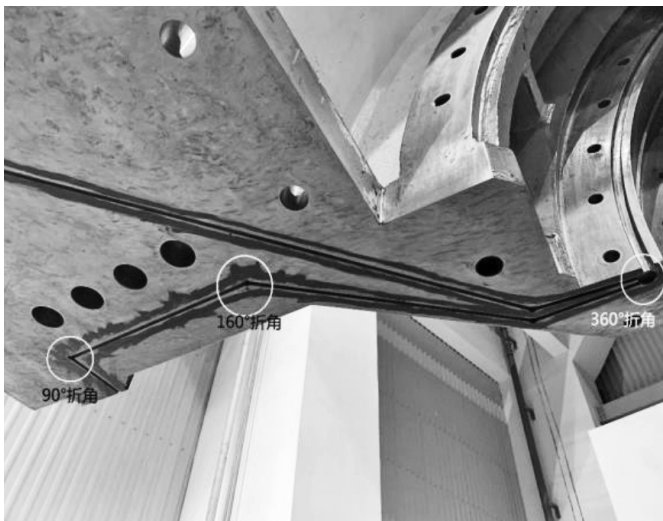
图 3 端盖中分面密封胶槽道
