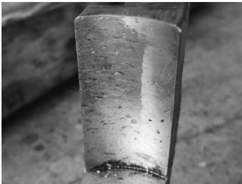
图 11 保持架窗孔形貌
