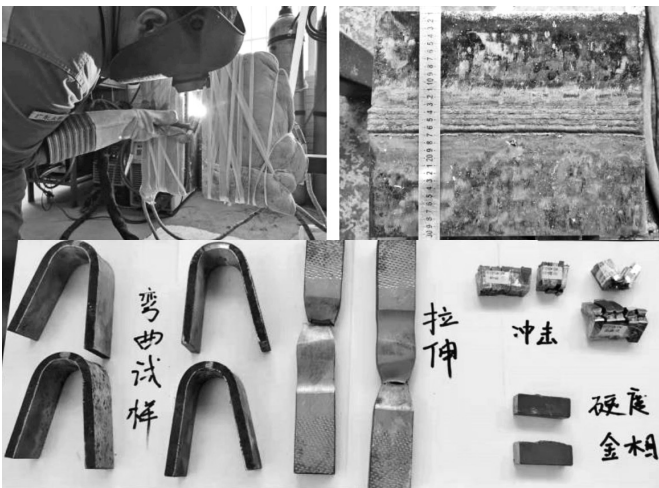
图 2 13MnNiMo5-4 试件焊接及试件理化检验试样
