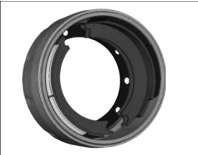
图 2 制动器有限元装配体模型
