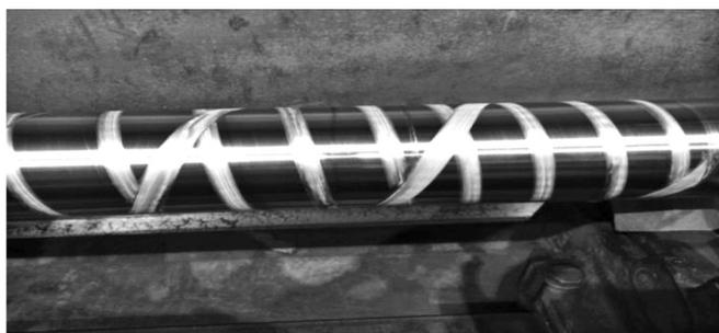
图1 磨削振痕图
