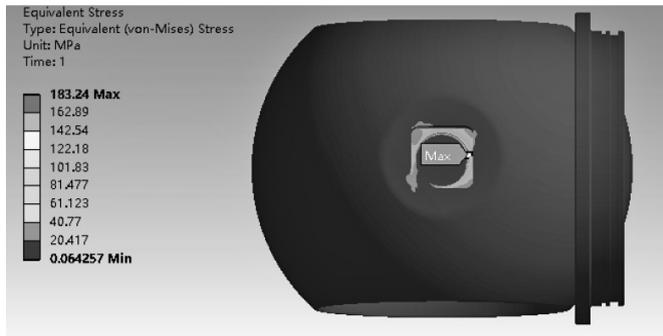
图 5 球体和阀座等效应力分布云图
