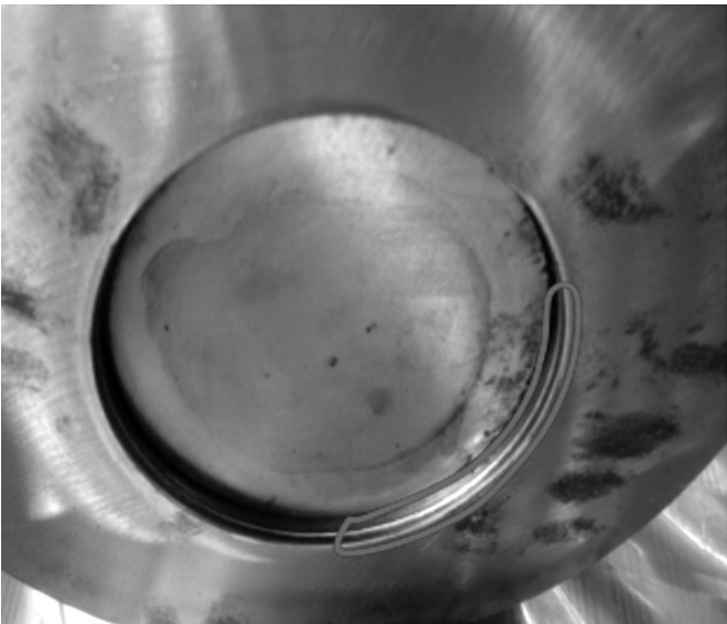
图 5 托盘底槽口边缘凹陷
