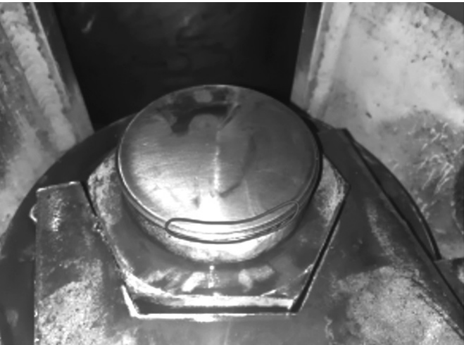
图 4 抗重螺栓球面边缘塌陷
