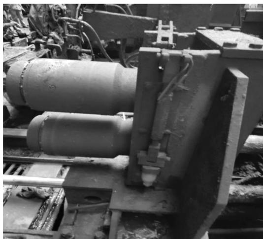
图 7 改造后的丝杠式调整器
