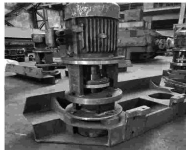
图4 改造前的裙板辊电机
