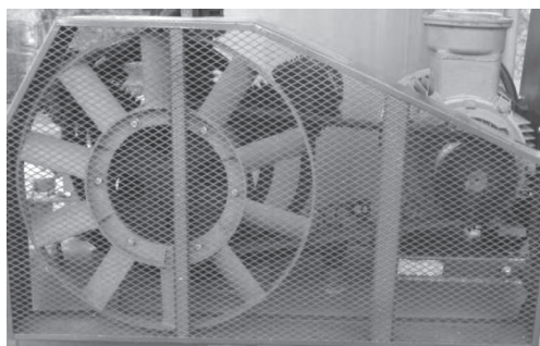
图 5 塑料飞轮(更换前)
