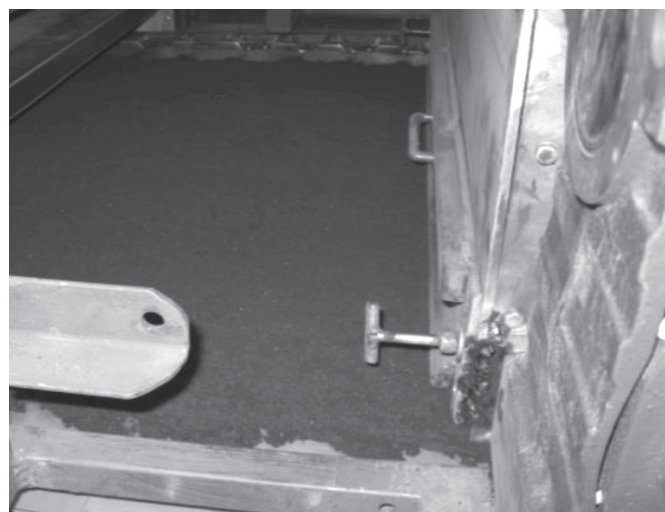
图 2 改进后的翻板布料装置布料效果图
