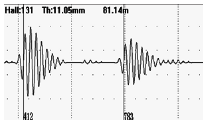
图 2a 本次检测最薄点 A 扫描
