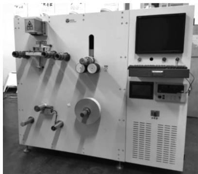
图 7 水松纸激光异形打孔机实物图
