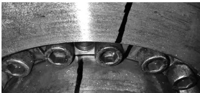
图2 同步轴和平移轴相对位移后
