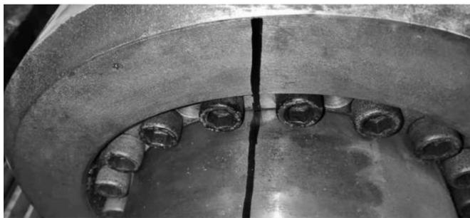
图1 同步轴和平移轴相对位移前
