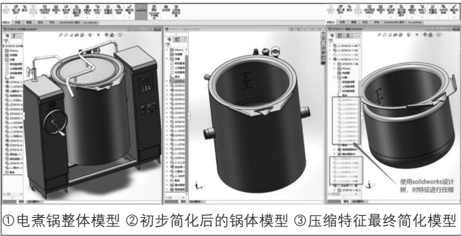
图 1 电煮锅产品及简化后的锅体模型
