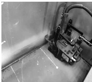
图 1 角焊小车 (平焊)
