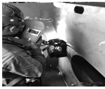
图 4 角焊小车 (立焊)
