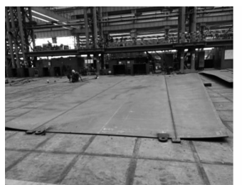
图 7 小线型埋弧自动焊拼板
